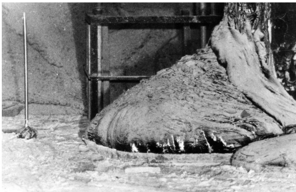
Obr. 3 – „Černobylská sloní noha“ – Korium vyteklé na chodby pod reaktorem [9]
