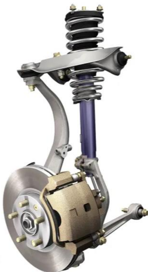
Obr. 23 Náprava s tlumičem uprostřed pružiny [37]
