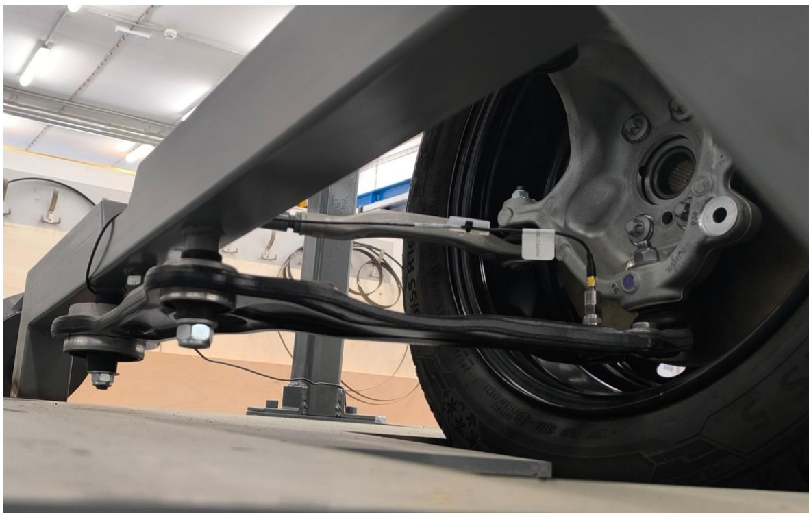
Obr. 42 Zavazbení ramene nápravy – laboratorní model [autor]
