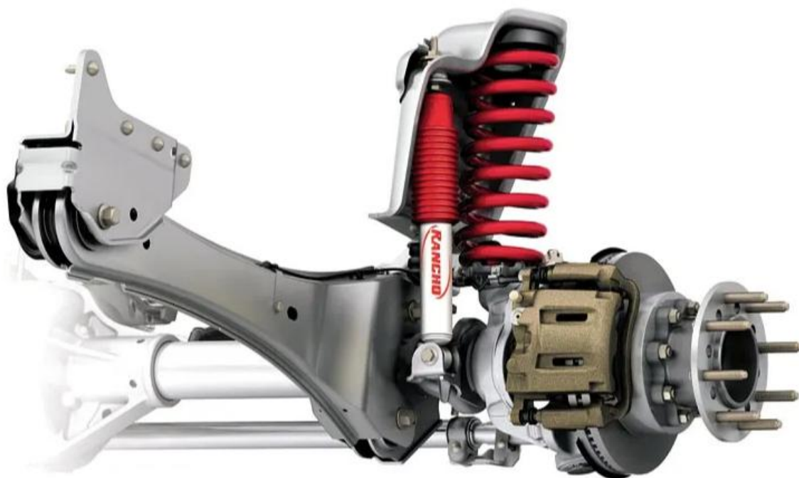
Obr. 23 Náprava s tlumičem uprostřed pružiny [37]
