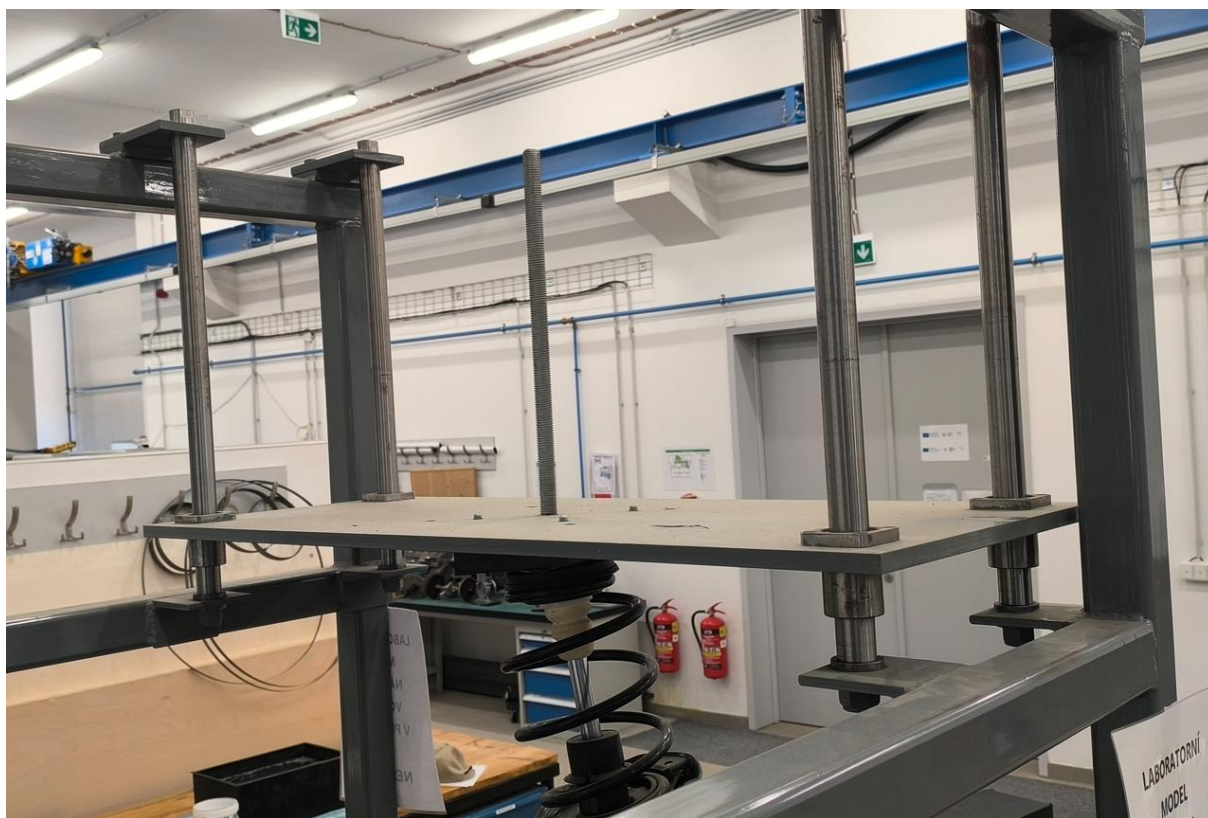
Obr. 44 Konstrukce desky pro vložení zátěže – laboratorní model [autor]
