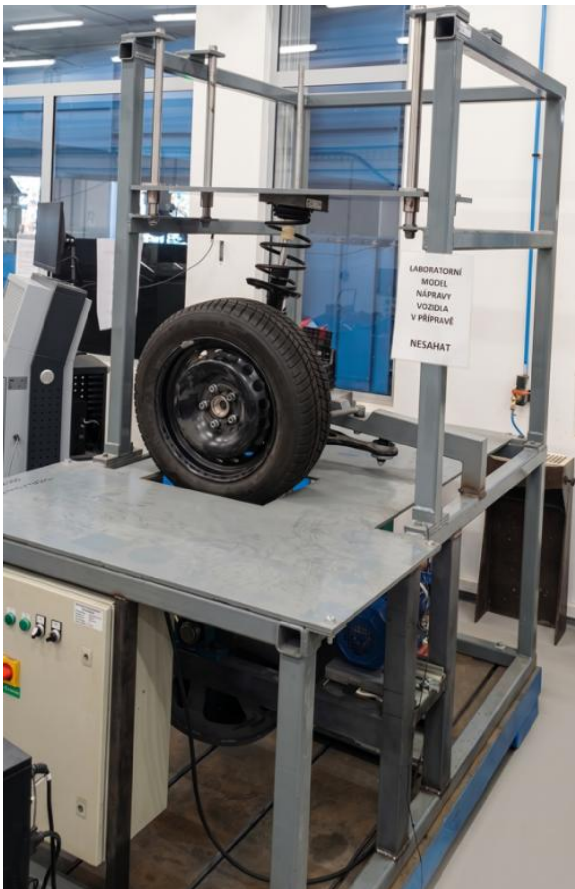
Obr. 37 Laboratorní model nápravy vozidla – přední pohled [autor]
