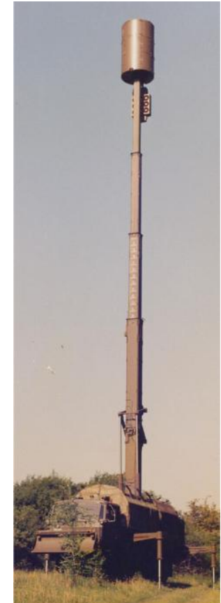
TAMARA - antény na teleskopu ve výšce 25 m
